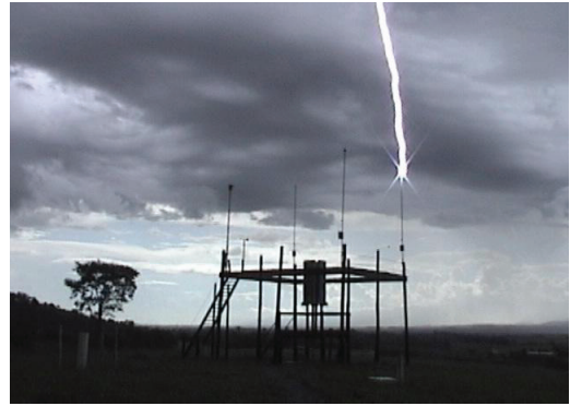
Fig. 1.9 - Descarga iniciada por foguete no campo de testes do INPE em Cachoeira Paulista - SP.
