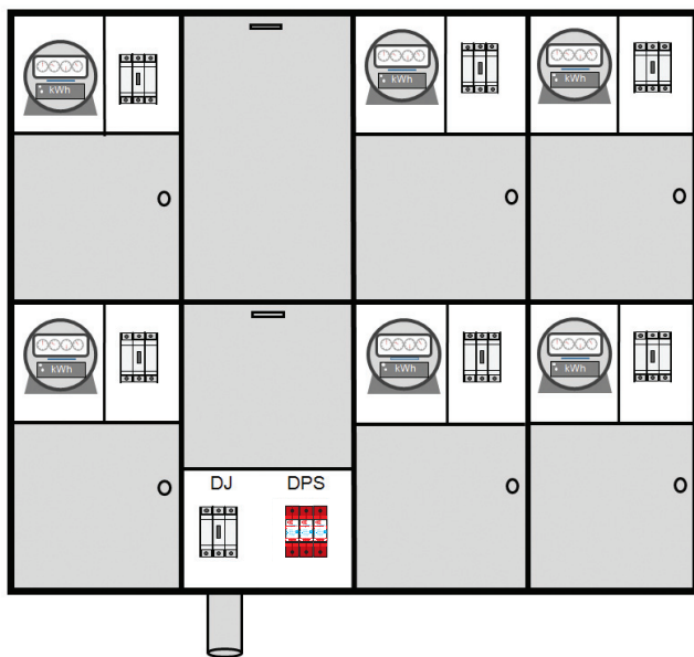
Fig.8.11 – Exemplo de instalação de DPS Classe I dentro da caixa de medição em rede 220/ 127V.
