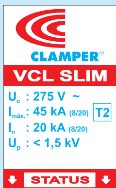
Fig. 8.1 – Identificação dos principais parâmetros de um DPS CLAMPER para redes elétricas. (A) DPS Classe I/II; (B) DPS Classe II.
