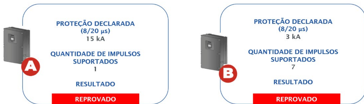
Figura 4 - Resultado dos testes de ciclo de operação dos inversores.
